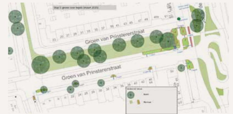
Uitvoering fase 2: 950 m2 onttegen – versmallen rijweg, open verharding parkeerplaatsen, verwijderen trottoir – extra bomen, wadi, afkoppelen, padden halfverharding, bloemenvelden
